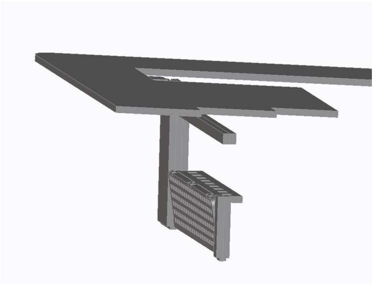
Den Klapptritt leicht nach außen Biegen und die Befestigungsfläche nach innen klappen.
