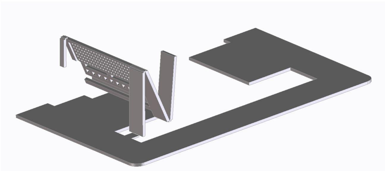
wie im Bild ersichtlich zusammenklappen, es kann geklebt oder vorzugsweise gelötet werden.
